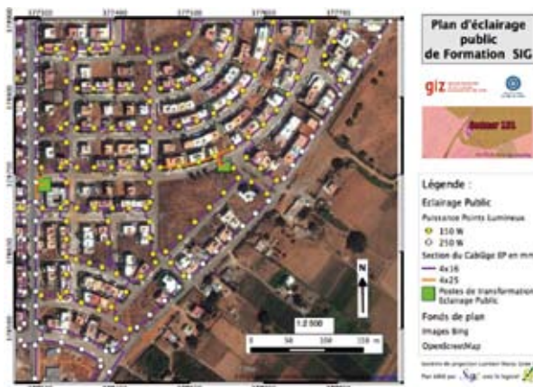
Figure 5 : Cartographie d'un réseau d'éclairage public générée à partir d'une base de données géoréférencée
